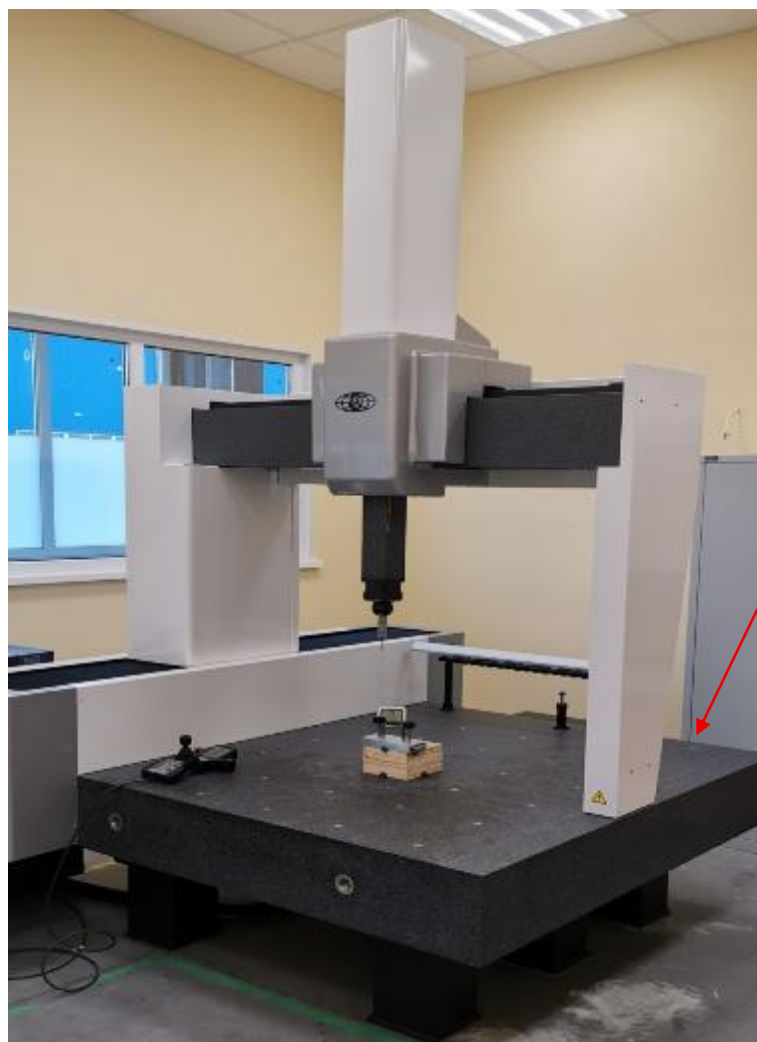
Рисунок 1 – Общий вид КИМ Leader с прямоугольным порталом и местом расположения маркировочной таблички
