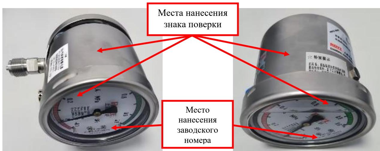
Рисунок 1 – Внешний вид, место нанесения знака поверки и место нанесения заводского номера манометров модификации ZDM
