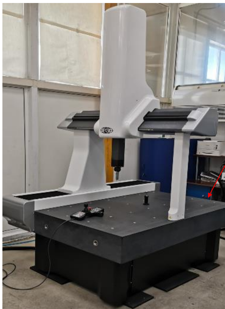
Рисунок 2 – Общий вид КИМ Leader с треугольным порталом и местом расположения маркировочной таблички
