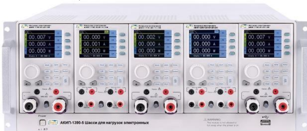
Рисунок 6 – Вид передней панели шасси АКПП-1390-5 с нагрузками
