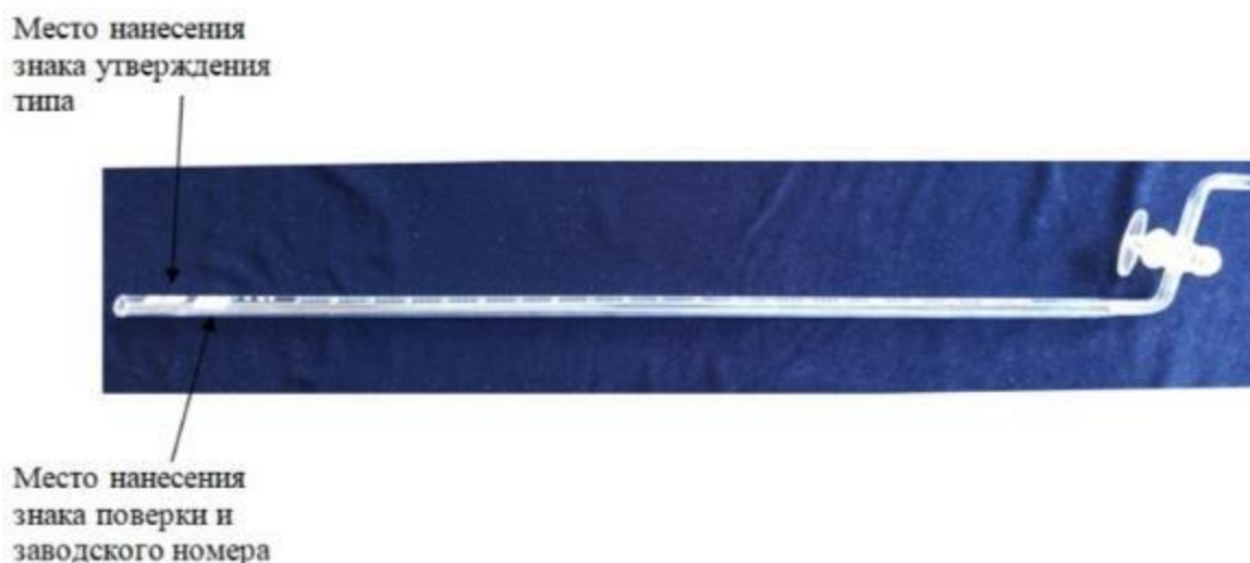
Рисунок 3 – Общий вид бюреток 1-го класса точности типа I исполнения 2 с указанием мест нанесения знака утверждения типа, знака поверки и заводского номера
