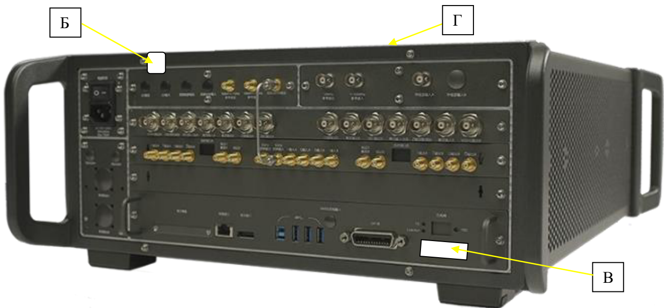
Рисунок 2 – Вид задней панели генераторов, места пломбировки от несанкционированного доступа (Б), места нанесения заводского номера (В) и знака поверки (Г)
