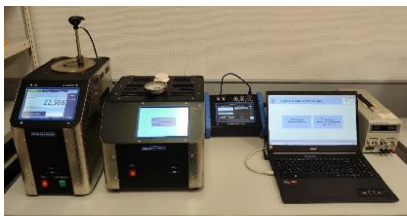
Рисунок 4 – Общий вид ИК воспроизведения температурных величин СИ и ИС тягового подвижного состава
