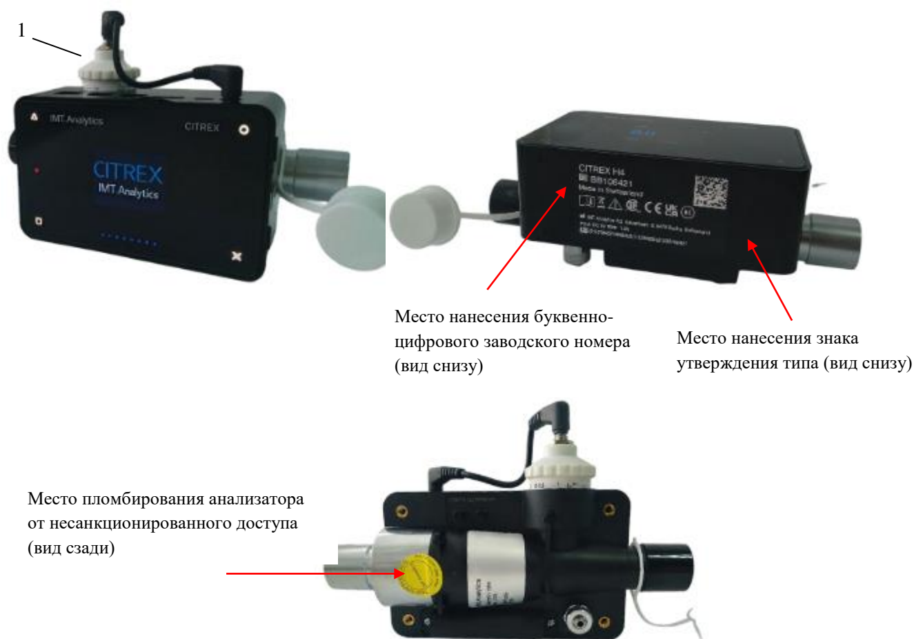
Рисунок 1 – Общий вид анализатора с указанием места нанесения знака утверждения типа, места нанесения буквенно-цифрового заводского номера и места пломбирования от несанкционированного доступа 1 – датчик кислорода
