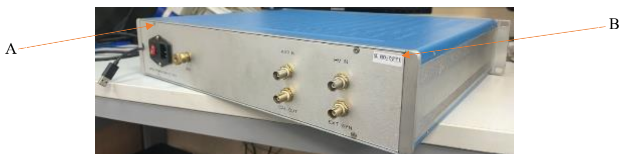
Рисунок 2 – Вид сзади блока измерительного D-22, обозначение мест пломбирования от несанкционированного доступа (А) и нанесения серийного номера (В)
